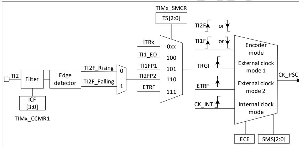
图 17-23 TI2 外部时钟连接例子
