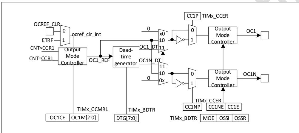
图 17-29 捕获/比较通道的输出部分(通道 1 至 3)
