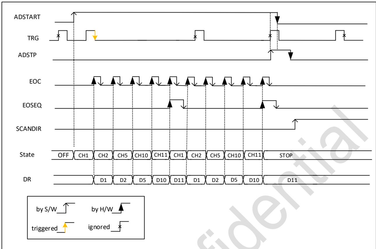
图 14-9 序列的连续转换，硬件触发
