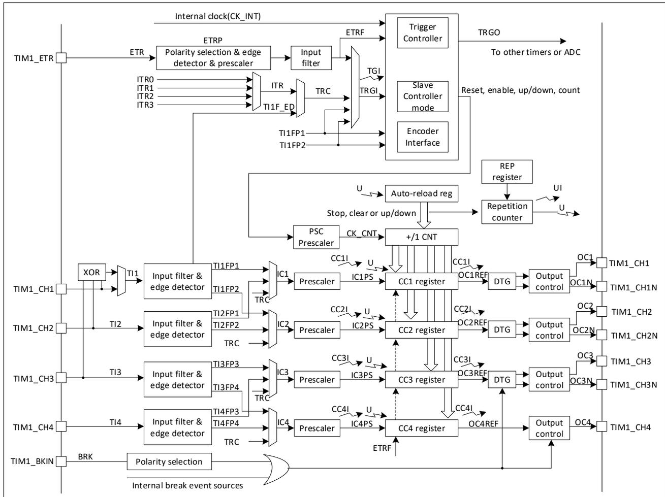
图 17-1 高级控制定时器架构框图
