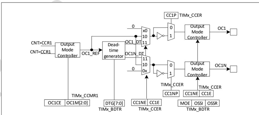
图 20-14 捕获/比较通道的输出部分(通道 1 )
