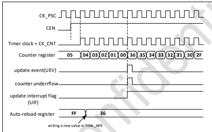
图 18-14 计数器时序图，当没有使用周期计数器时的更新事件
