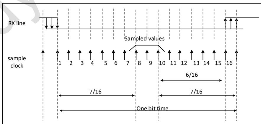
图 26-6 检测噪声的数据采样
