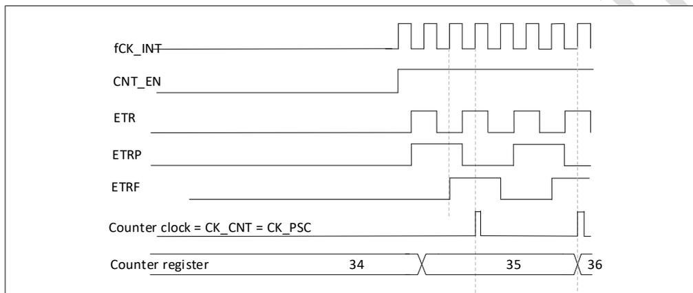
图 17-26 外部时钟模式 2 下的控制电路
