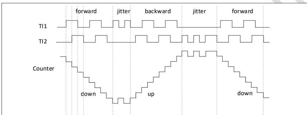
图 17-43 IC1FP1 反相的编码器接口模式实例
