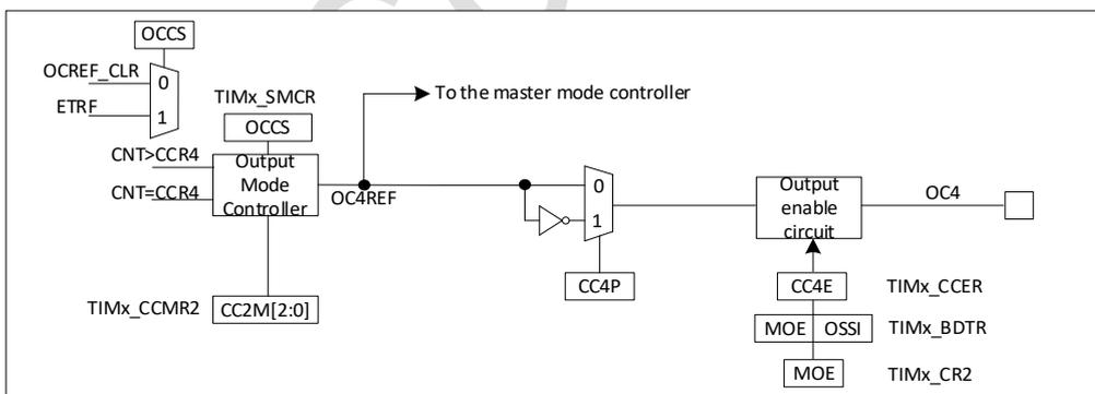
图 17-30 捕获/比较通道的输出部分(通道 4)
