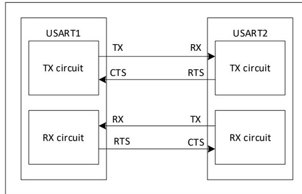
图 26-14 两个 USART 间的硬件流控制
