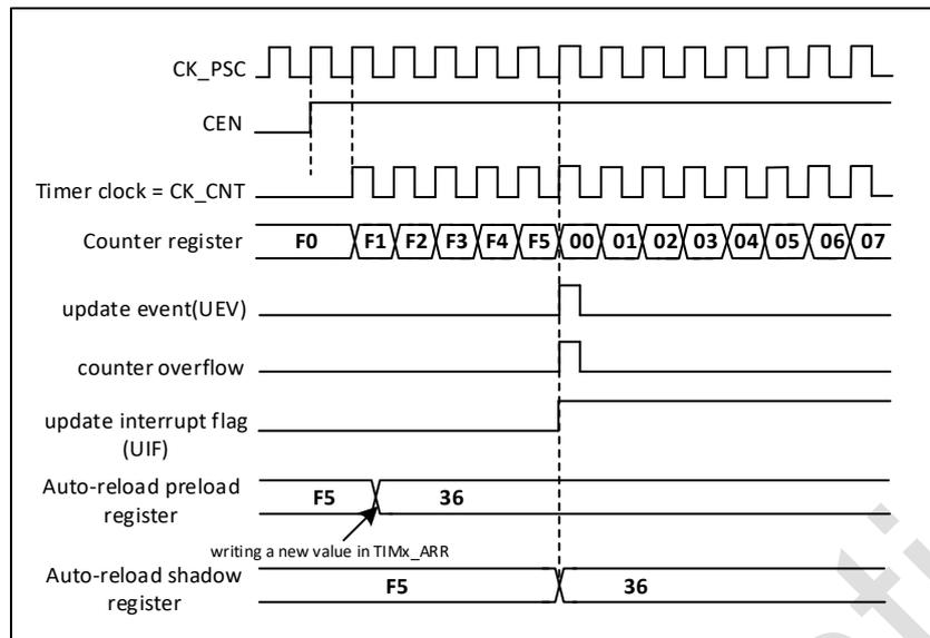
图 18-9 计数器时序图，当 ARPE=1 时的更新事件(预装入了 TIMx\_ARR)
