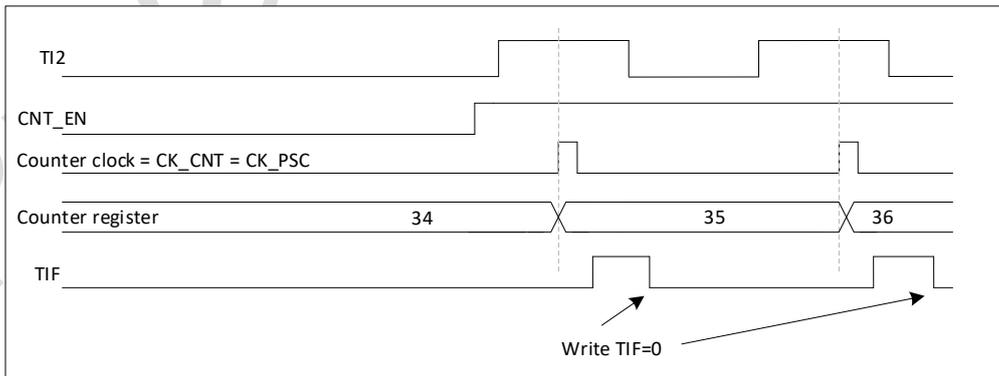
图 17-24 外部时钟模式 1 下的控制电路
