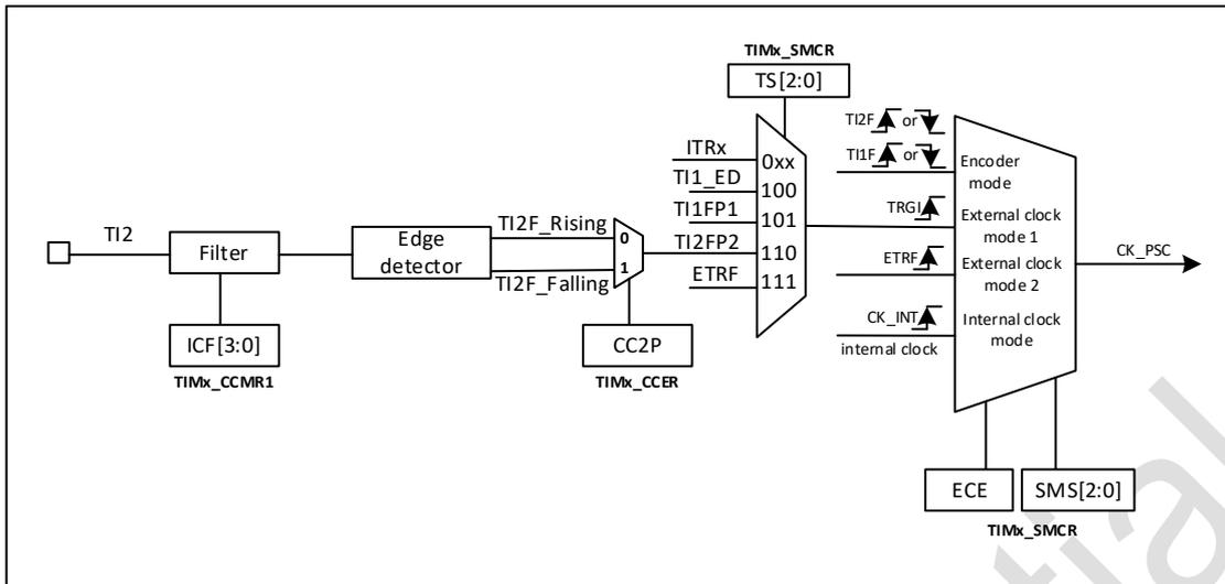
图 18-22 TI2 外部时钟连接示例
