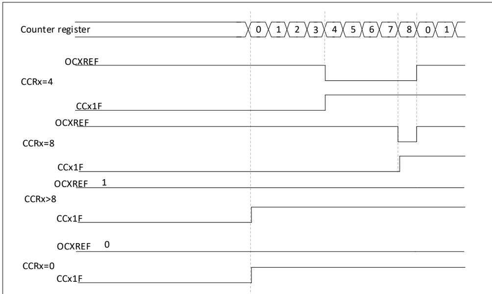
图 17-33 边沿对齐方式 PWM 输出，向上 (ARR=8)
