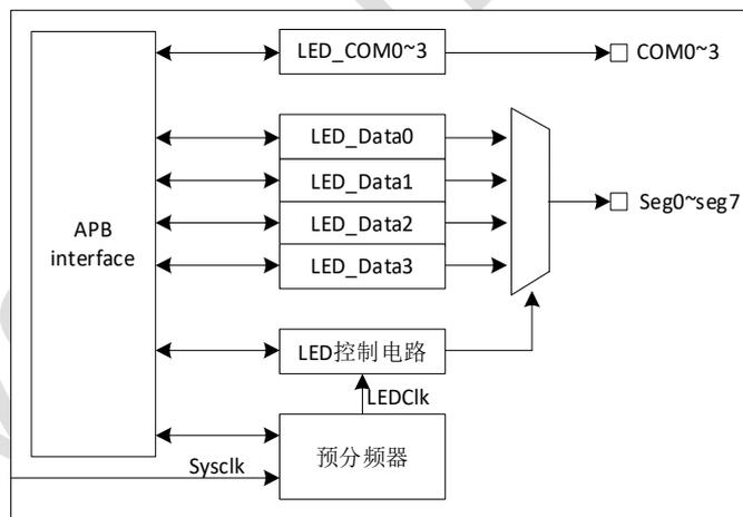
图 16-2 LED 架构图
