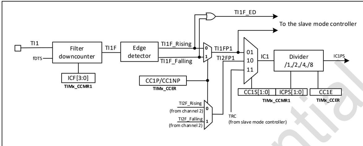
图 18-24 捕获/比较通道(如：通道 1 输入部分)
