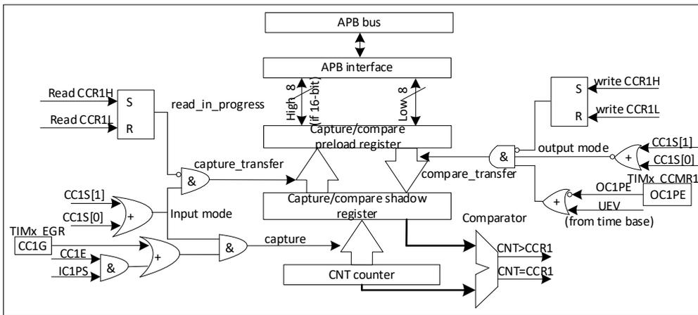
图 17-28 捕获/比较通道 1 的主电路
