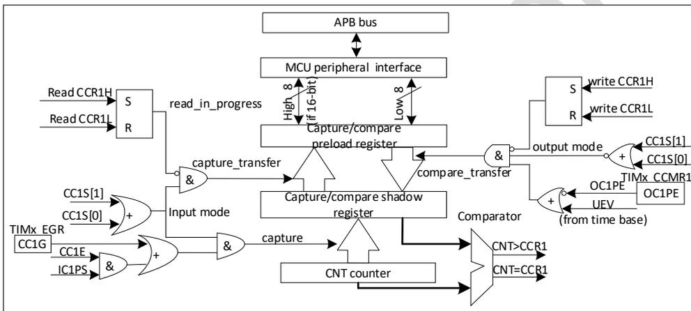
图 20-13 捕获/比较通道 1 的主电路
