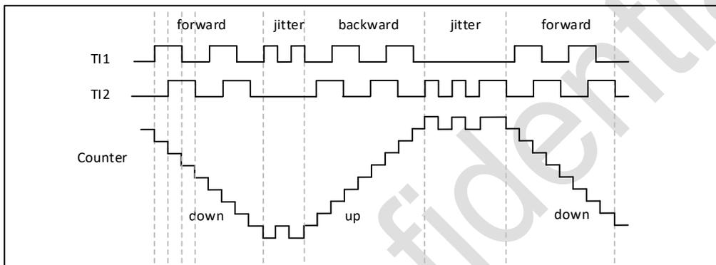
图 18-33 IC1FP1 反相的编码器接口模式实例
