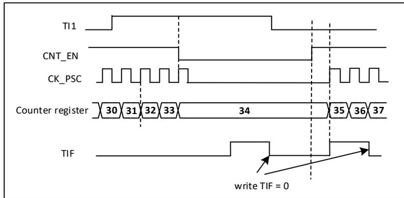
图 18-35 门控模式下的控制电路
