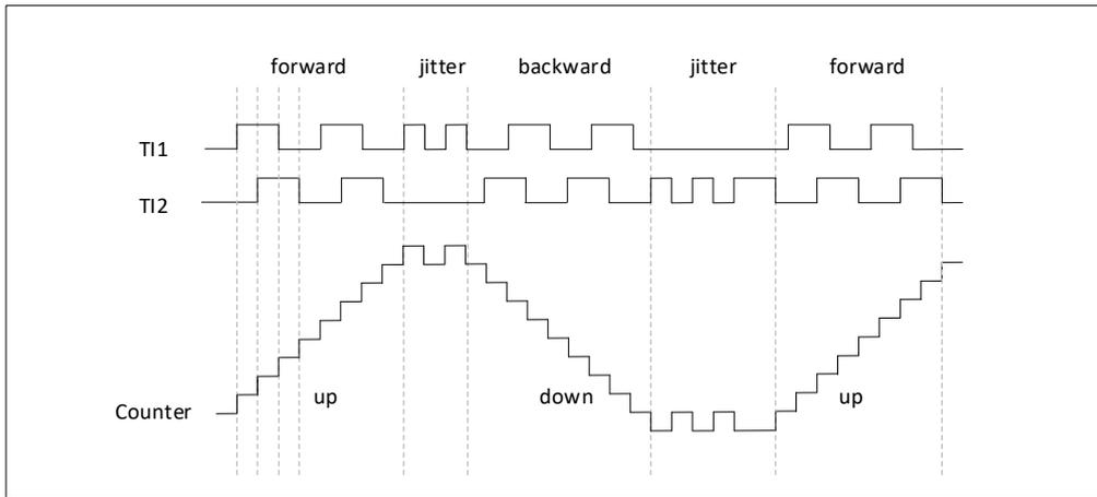
图 17-42 编码器模式下的计数器操作实例
