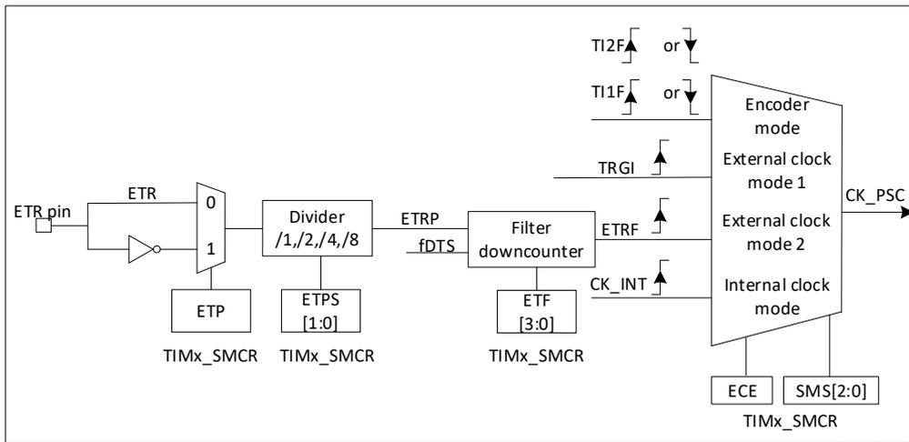
图 17-25 TI2 外部触发输入框图
