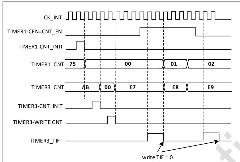
图 18-40 通过使能定时器 1 可以控制定时器 3
