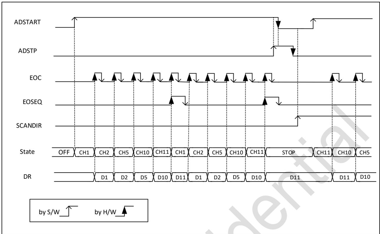
图 14-7 序列的连续转换, 软件触发
