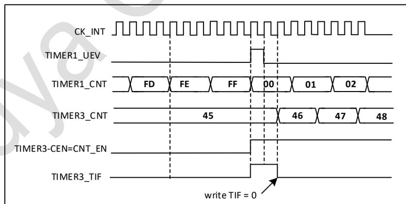
图 18-41 使用定时器 1 的更新触发定时器 3
