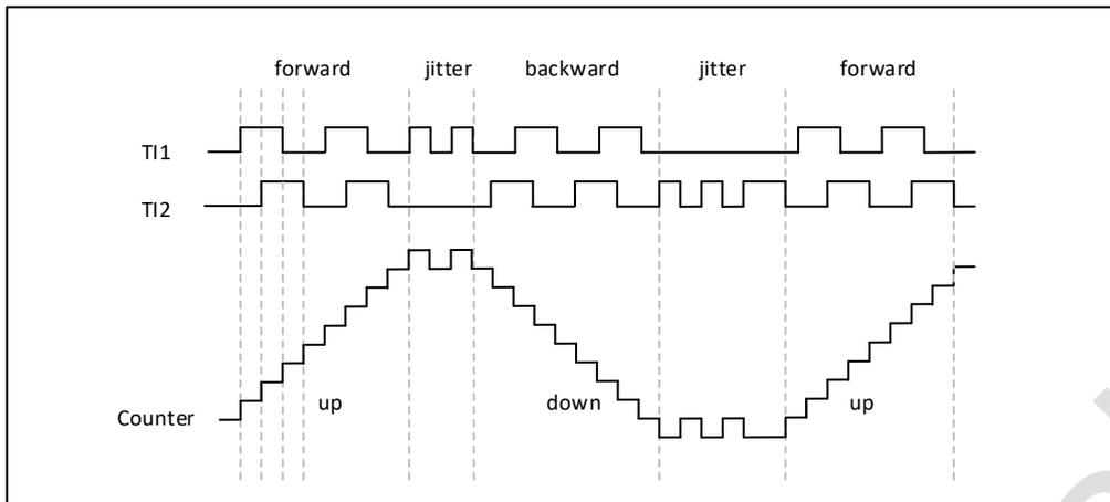
图 18-32 编码器模式下的计数器操作实例
