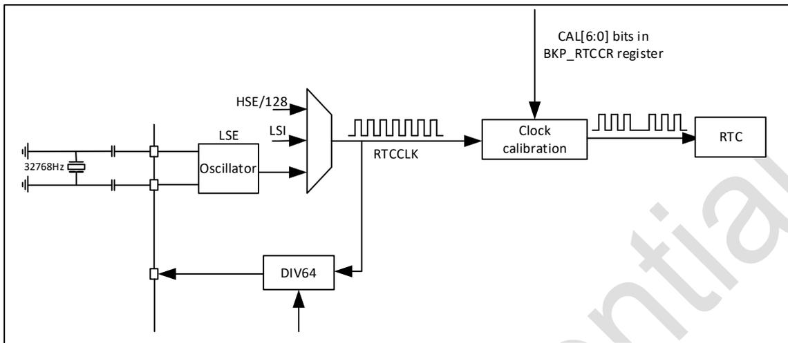
图 24-4 RTC 校准图
