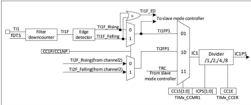
图 20-12 捕获/比较通道(如：通道 1 输入部分)
