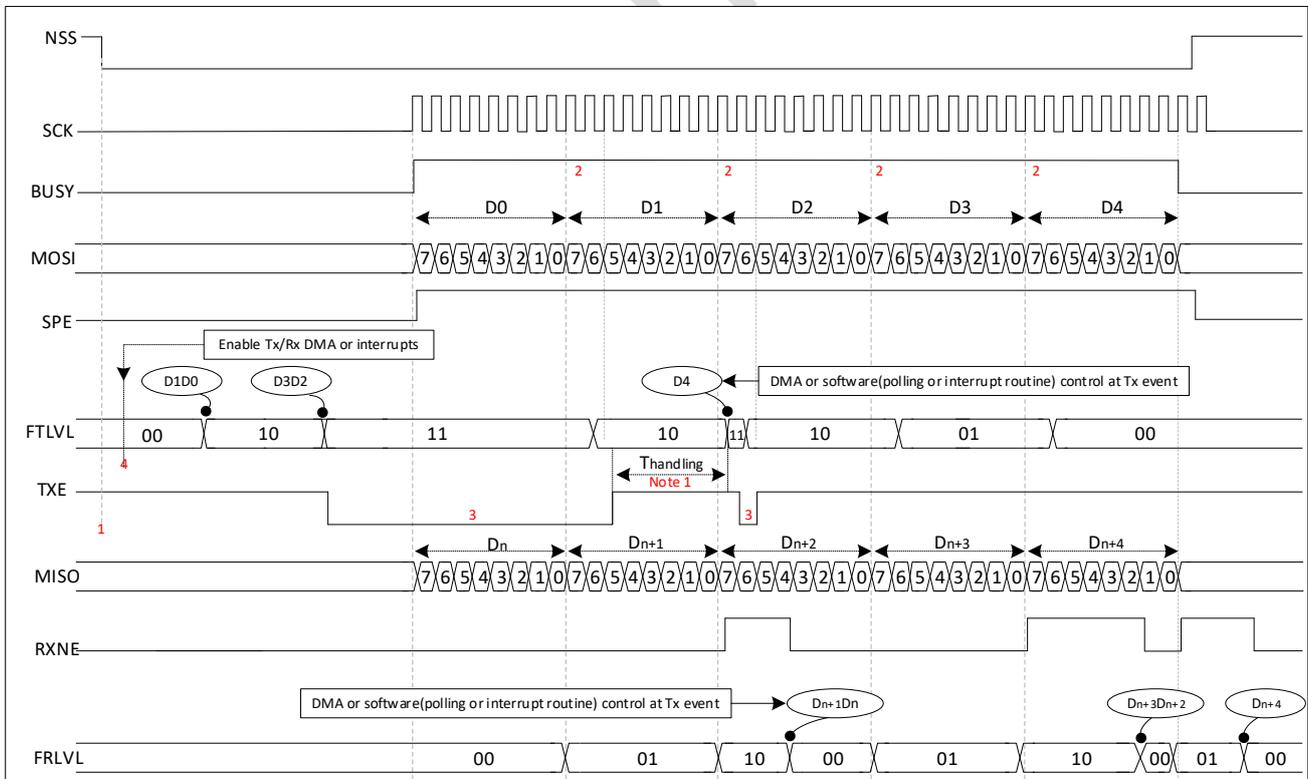
图 27-10 主机 full-duplex communication diagram(bit frame=8, FRXTH=0)
