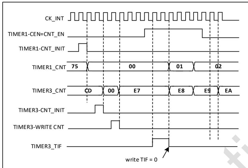
图 18-42 利用定时器 1 的使能触发定时器 3
