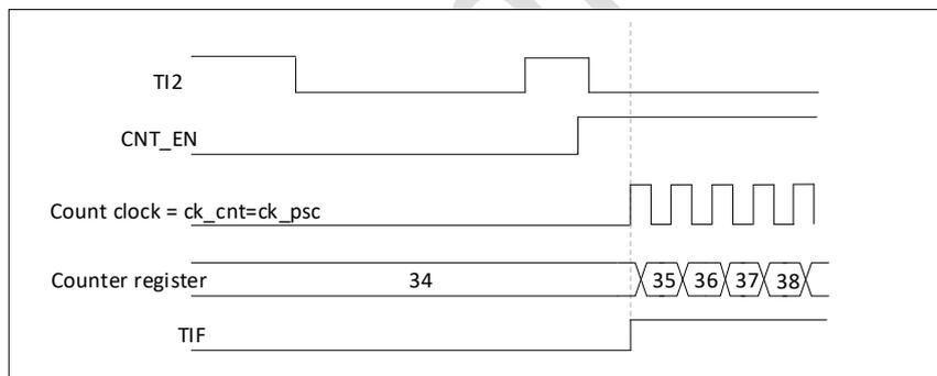
图 17-47 门控模式下的控制电路
