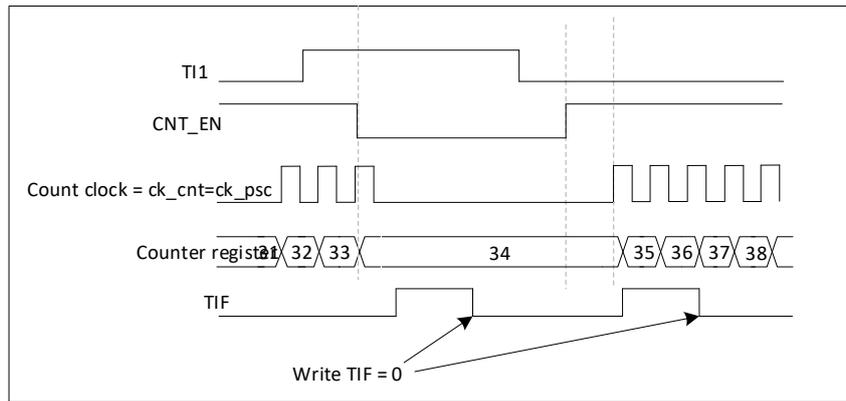
图 17-46 门控模式下的控制电路
